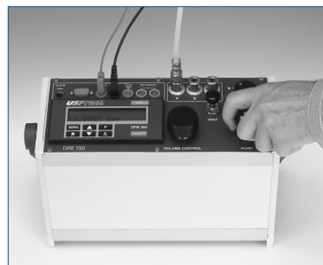
Při pumpování ve svislé poloze není potřeba přístroj přidržovat ani o nic opírat.
