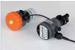
Obr. 4. Ultrazvukový snímač polohy hladiny UFM: vlevo vysílač/přijímač ultrazvukového signálu (na víčku přístroje je patrná libela pro snadší nastavení svislé polohy), vpravo je vyhodnocovací a ukazovací jednotka s UNI displejem, z jednotky je sejmuto průhledné víčko
