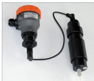
Obr. 2. Hydrostatický snímač výšky hladiny s probublávacím: vpravo kompresor se snímačem tlaku, vlevo řídicí a zobrazovací jednotka
