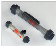
Obr. 1. Plovákové průtokoměry typu DFM: v popředí trubice světlosti DN20 s namontovaným limitním snímačem polohy plováčku, vzadu DN40 se spojitým snímačem polohy plováčku
