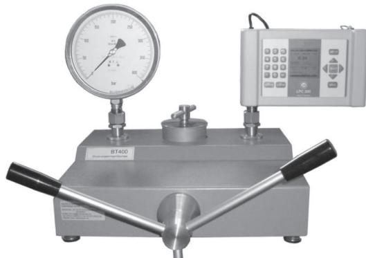
С удлинительным кабелем (по заказу, код заказа LPC-KABEL, длиной ок. 1.1м) эталонный датчик LPC-S можно использовать как "внешний", т.е. хотя датчик монтируется прямо на источник давления, сам калибратор LPC 300 может быть помещён отдельно, например на столе:
