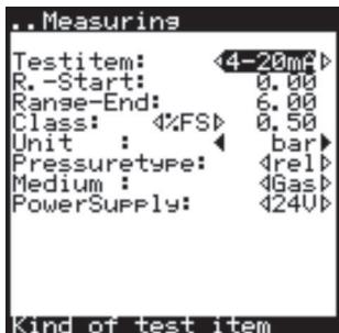
"Testitem:" выберите тип ТУ, соотв. выходной сигнал:
