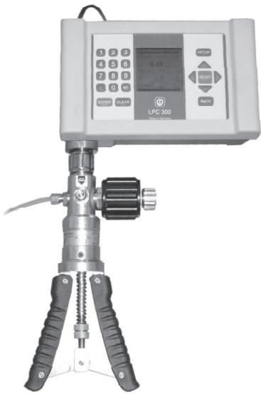
Набор для калибровки с компаратором давления (винтовым насосом) в качестве источника создания давления
